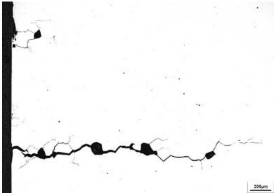
Härteriß, ungeätzter Schliff
